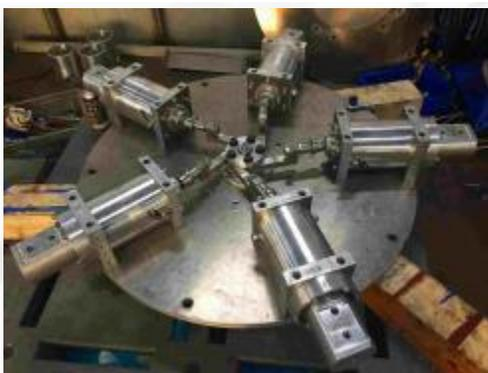
機械式過回転抑制機構
