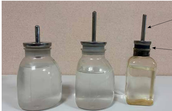
大瓶 A (旧型) 先管が短く太い
