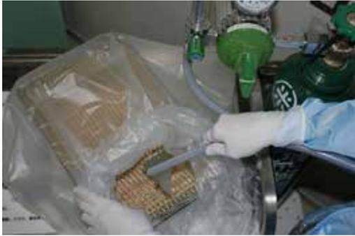
2. 減圧弁を右に回して、炭酸ガスを注入する。
