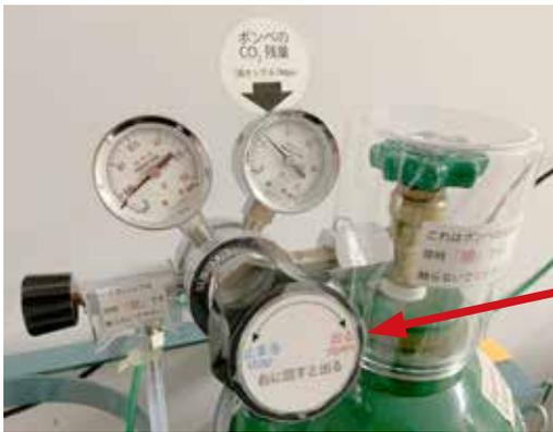
3. 処置が終わったら、減圧弁を左に回して炭酸ガスを止める。
